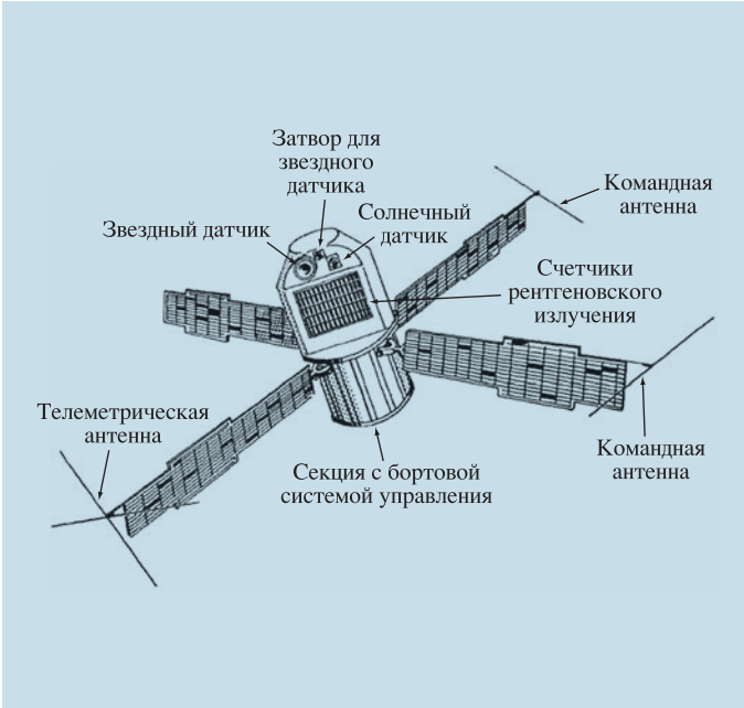
Устройство космической рентгеновской обсерватории "SAS-A" ("Ухуру"; США). Рисунок NASA.
